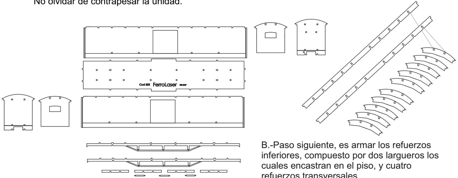
B.-Paso siguiente, es armar los refuerzos inferiores, compuesto por dos largueros los cuales encastran en el piso, y cuatro refuerzos transversales.
